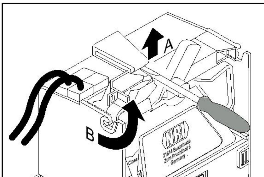
Рис. 2. Снятие головки монетоприемника.
