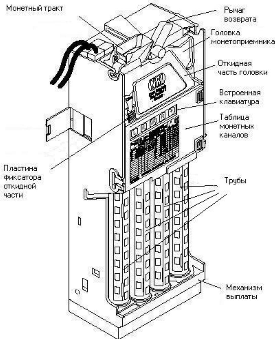
Рис. 1 Конструкция монетоприемника.
